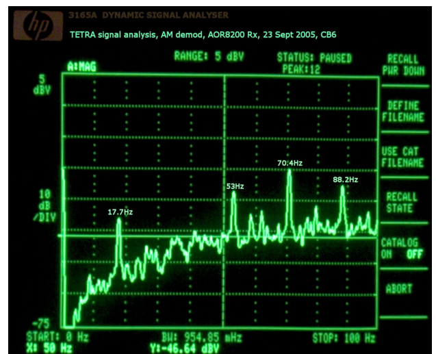
Abb. 2-2: Spektrumanalyse des TETRA-Signals, dominierender Peak bei ca. 70,4 Hz.
